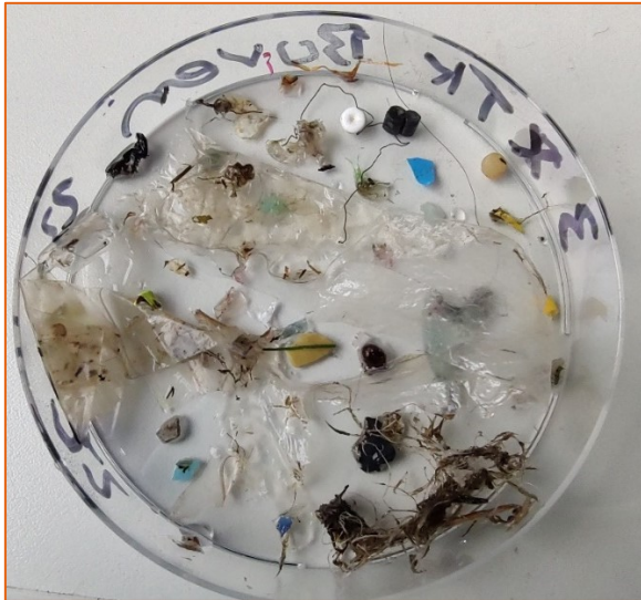
Figuur 6 Twee voorbeelden van petrischalen met verzamelde plastics uit monsters uit de Boven-Rijn (foto: ATKB)
