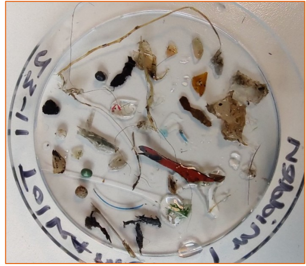
Figuur 6 Twee voorbeelden van petrischalen met verzamelde plastics uit monsters uit de Boven-Rijn (foto: ATKB)
