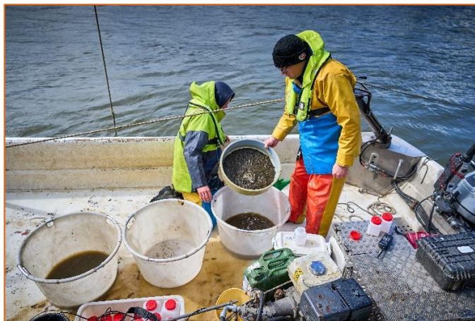
Figuur 13. Het zeven van monstermateriaal (links) en het resultaat van een (gezeefd) monster, gereed om opgeslagen te worden in een monsterpot (rechts). De Monsterpotten zijn op deze foto's herkenbaar door de rode deksels. (foto: Phil Nijhuis).
