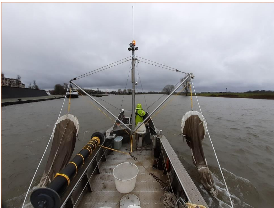
Figuur 9. Opzet van mobiele metingen vanaf een werkboot op de IJssel bij Doesburg in 2023. Op deze foto vaart een boot na een uitgevoerde meting terug naar de oever voor verwerking van de monsters. De netten zijn op deze foto duidelijk vol geslibd met organisch materiaal. In dit geval is gebruik gemaakt van hydraulische mogelijkheden voor het ophalen en laten zakken van de netten (foto: ATKB).
