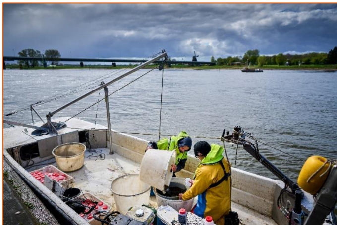
Figuur 13. Het zeven van monstermateriaal (links) en het resultaat van een (gezeefd) monster, gereed om opgeslagen te worden in een monsterpot (rechts). De Monsterpotten zijn op deze foto's herkenbaar door de rode deksels. (foto: Phil Nijhuis).
