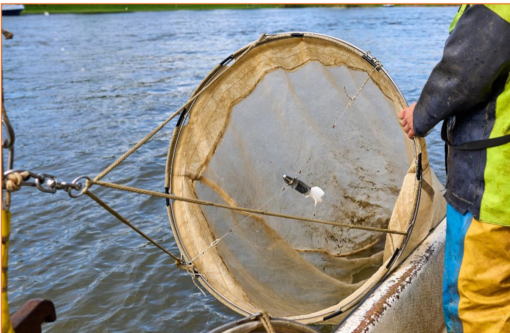
Figuur 10. Aan een dunne lijn gemonteerde stroomsnelheidsmeter in het midden van een rond net (foto: Phil Nijhuis).
