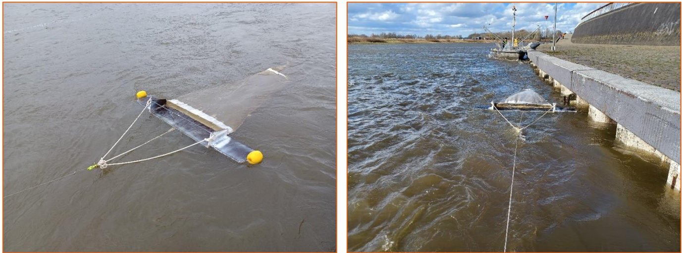
Figuur 7. Inzet van de manta trawl voor monitoring van zwerfafval aan de oppervlakte van stromende wateren (foto's: ATKB). Voor de hier toegepaste constructie is 1,8 mm betonplex gebruikt voor de 'vleugel'.
