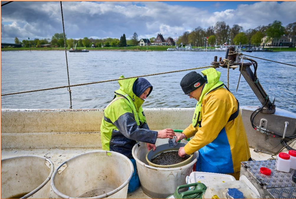
Figuur 15. Het handmatig overbrengen van monstermateriaal in een monsterpot. Op de foto is goed te zien dat op de gebruikte monsterpot de monstergegevens zijn genoteerd (foto: Phil Nijhuis).
