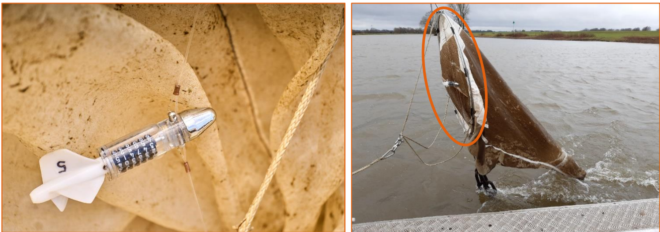
Figuur 3. Weergave van een stroomsnelheidsmeter (links; foto: Phil Nijhuis) en de wijze van montage in de instroomopening van een net aan een dunne lijn (rechts, binnen rode omlijning; foto: ATKB).
