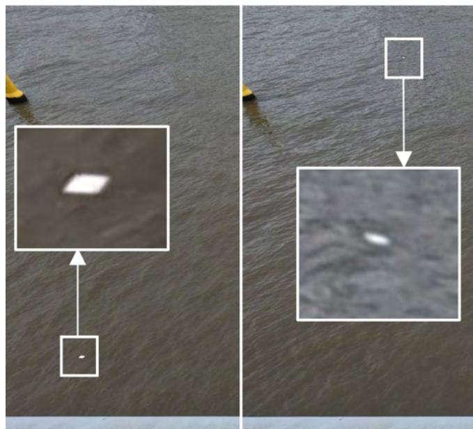
Figuur 4.1 Detectie van een wit plastic zwerfafval item vanaf een 12,5 m hoge brug (Erasmusbrug, Rotterdam) op 5.3K film (GoPro Hero 11 camera). De subfiguur links laat detectie dicht bij de brug zien, de subfiguur rechts ver van de brug
