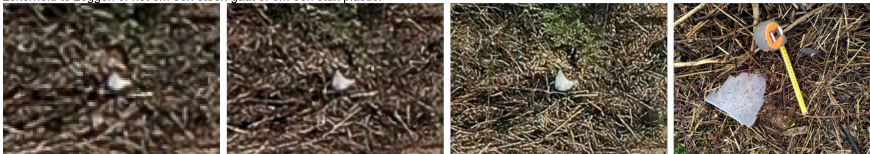
Figuur 5.2 Een plastic object ingemeten met vanaf links naar rechts een camera vanaf 88 meter, een camera vanaf 62 meter, een camera vanaf 36 meter en een ter plekke handgenomen foto
