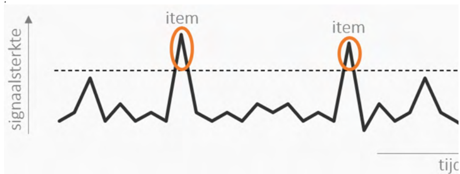
Figuur B3.2 Bepaling van itemaantal met behulp van sonardata. Boven een drempelwaarde (stippellijn) wordt een bepaalde signaalsterkte die de sonar heeft ontvangen beschouwd als een item (oranje cirkel)
