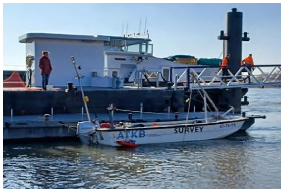
Figuur B3.1 Links: Schematisch weergave van ADCP- en netmetingen (alleen het gebruikte net op de middelste diepte weergegeven), midden: meetopstelling aan een ponton in de Rijn bij Tolkamer, met aan de achterkant van de boot de ADCP aan een rode drijver en netten aan een kraan aan de voorkant van de boot, rechts: voorbeeld van de inhoud bestaande uit organisch materiaal en zwerfafval uit een net na een meetperiode
