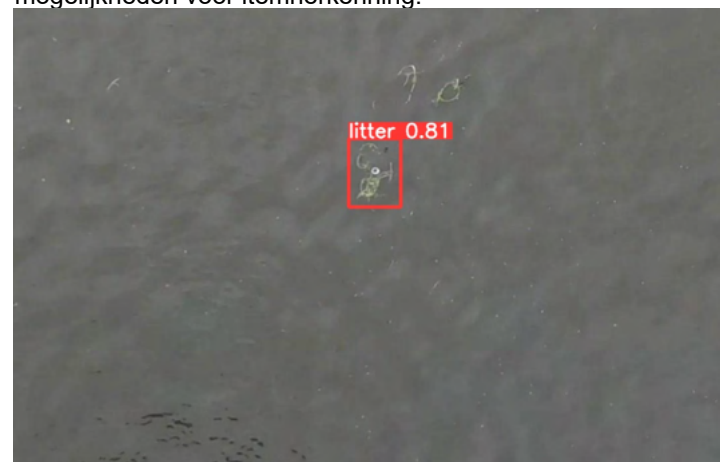
Figuur 4.3: Eerste resultaten uit het onderzoek van de TU Delft waarbij AI-technologie is ingezet voor detectie en identificatie van drijvende objecten (uit stationaire camerabeelden vanaf een brug)
