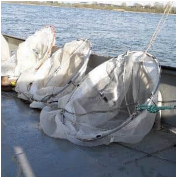
Foto 3 De vervuiling van de netten is duidelijk zichtbaar. Links de schone netten, klaar voor gebruik. Rechts een net tijdens het lichten, na een periode van monitoring.
