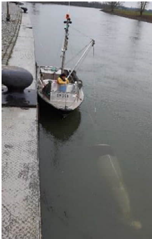
Foto 1 Monitoring in de praktijk; liggend aan de IJsselkade te Deventer. Het bovenste net is duidelijk zichtbaar. De boot ligt met de punt stroomafwaarts i.v.m. de nettenrol die zich aan de bakboordzijde bevindt.
